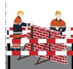
Rys. 1. Zabezpieczenie ścian murowanych przed przewróceniem poprzez wsporniki
