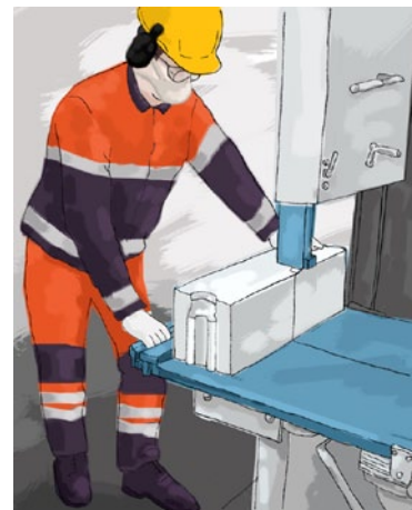
Rys. 6. Bezpieczeństwo i higiena pracy podczas piłowania cegieł
