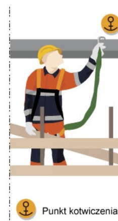
Rys. 2. Ochrona indywidualna przed upadkiem z wysokości
