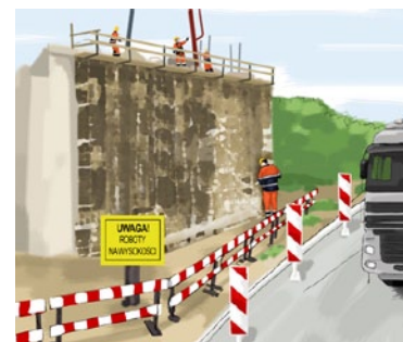
Rys. 1. Zabezpieczenie i oznakowanie terenu prac na wysokości
