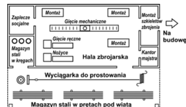
Rys. 1. Schemat warsztatu zbrojarskiego
