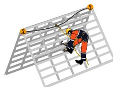
Rys. 4. Metoda pracy na wysokości w autoasekuracji
