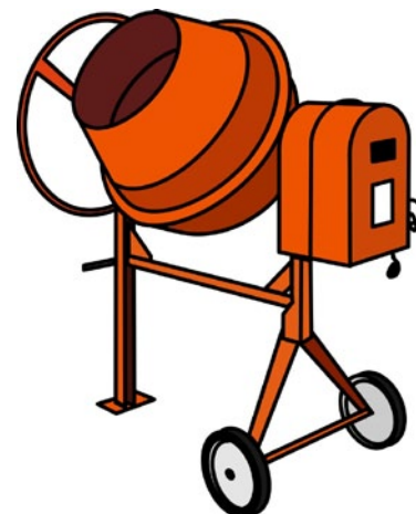
Rys. 3. Sprzęt do betonowania – betoniarka o mocy do 1 kW (nie wymaga uprawnień)
