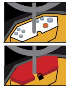
Rys. 9. Zabezpieczenie elementów sterowniczych maszyny
