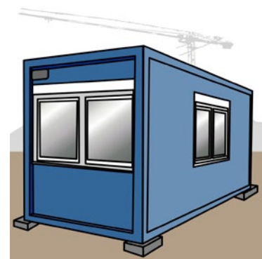
Rys. 5. Usytuowanie kontenera na bloczkach betonowych
