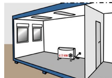
Rys. 4. Ogrzewanie kontenerów ogrzewaczem elektrycznym
