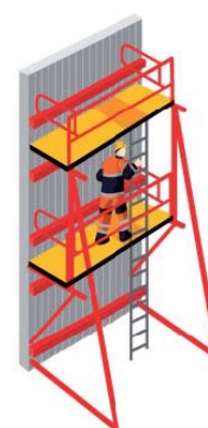
Rys. 2. Pomosty robocze deskowań
