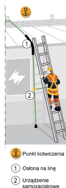
Rys. 3. Bezpieczne wejście na dach
