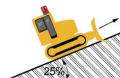
Rys. 2. Praca spycharek na pochyłościach podczas pracy pod górę
