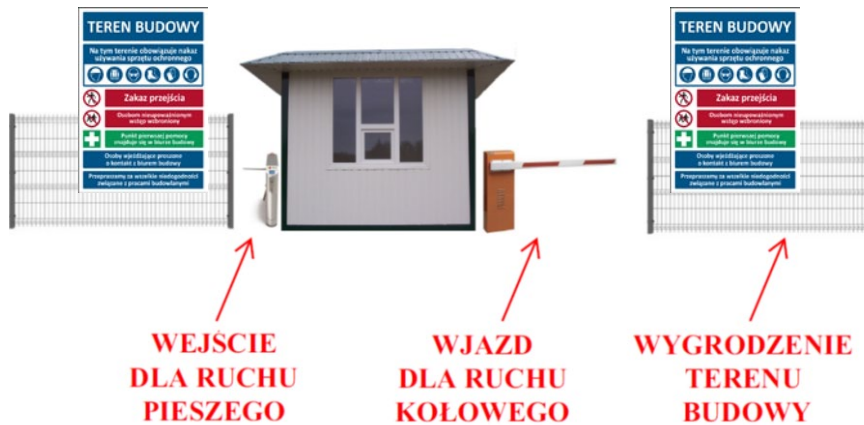
Rys. 1. Wejście/wyjście oraz wjazd na teren budowy.
