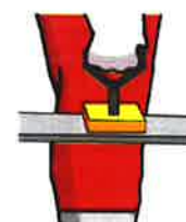
Rys. 5. Przenoszenie nieporęcznych przedmiotów za pomocą chwytaka z głowicą z tworzywa sztucznego
