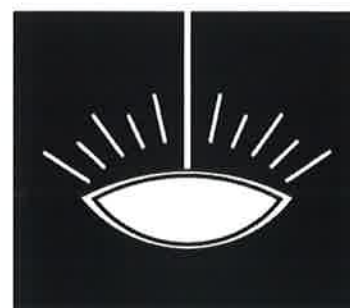
Rys. 2. Oprawa przy oświetleniu bezpośrednim
