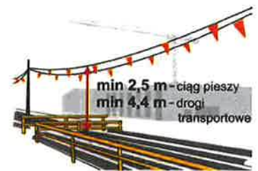
Rys. 1. Wysokość powieszenia przewodów ruchomych
