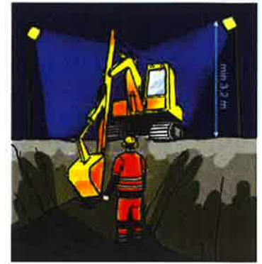
Rys. 5. Oświetlenie placu budowy
