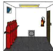
Rys. 7. Magazyn gazów technicznych w budynku
