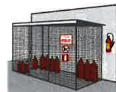
Rys. 10. Magazyn gazów technicznych na wolnym powietrzu
